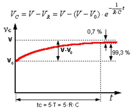
Si suponemos el condensador inicialmente descargado:  $V_0 = 0$ .
