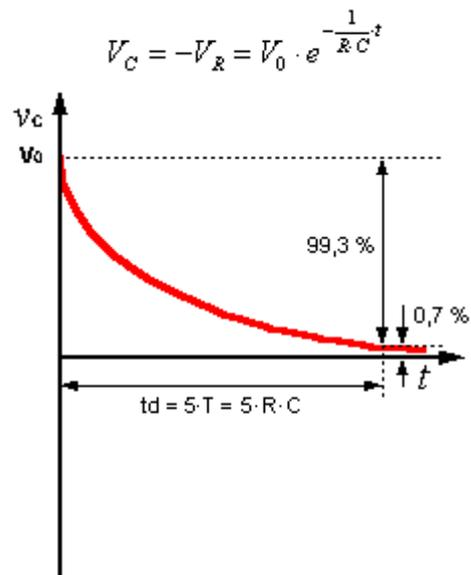
Al cabo de un tiempo en segundos igual al producto  $R \cdot C$  el condensador se ha descargado en un 63,2% y después de 5 veces este tiempo lo está al 99,3% quedando una tensión residual del 0,7%.
