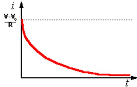
Por la ley de Ohm obtenemos la tensión en la resistencia y en el condensador
