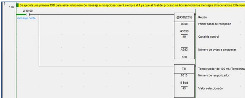
La instrucción RXD funciona básicamente como la TXD, hay que configurar tres datos: en el primero se escriben los códigos que utiliza el módem según el comando a utilizar. El segundo hace referencia al puerto a utilizar y el tercero al número de Bytes a recibir.
