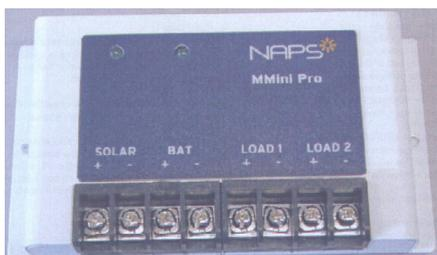
Regulador para 12/24v, entrada max. 5 amp. Y salida max. 2 x 7 amp (1 salida "load 1" con temporizador horario automático programable o con posibilidad de encender una luz al oscurecerse (el panel solar funciona como una célula fotoeléctrica)
