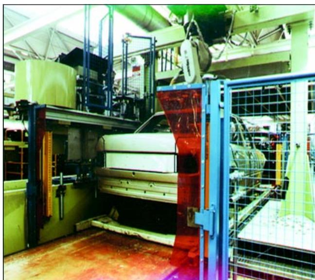
En la imagen podemos ver el ejemplo de un sistema de seguridad instalado en una línea robótica de la industria de automoción. Se pueden observar las formas suplementarias de protección instaladas en la parte lateral de la línea de montaje, las cuales impiden que el operador salga fuera de la zona protegida (adición de piezas de plástico rojo en los lados de la línea automatizada).
