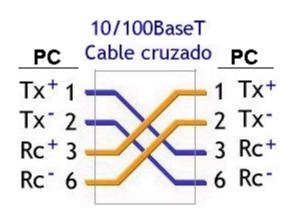
etc., equipos que más adelante veremos y que tienen cambiadas las funciones de los pines 1, 2, 3 y 6. En un equipo transmiten datos y en el otro los reciben.
