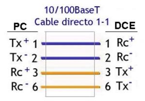
Este tipo de cable se utiliza para unir un **DTE** (*Data Terminal Equipment*), tal como un ordenador, con un **DCE** (*Data Conmunication Equipment*), tal como un hub, switch,
