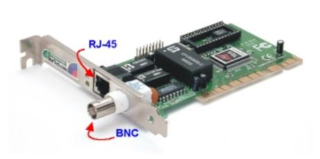
Algunas tarjetas de red pueden venir con los dos primeros tipos de conector (BNC y RJ45). Si sólo traen el BNC son de 10 Mbps; si son de 100 Mbps traerán sólo el conector RJ45, y si son 10/100 pueden traer ambos o sólo el RJ45.
