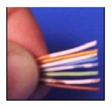
Introdúcelos dentro del conector RJ-45 para comprobar si su longitud es la adecuada.
