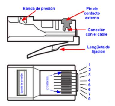
Pero ¿cómo hemos de distribuir los 8 hilos en el conector? Según el estándar EIA/TIA 568, se establecen dos esquemas de conexión: el EIA/TIA 568A (o *ISDN*) y el EIA/TIA 568B (o *AT&T*).
