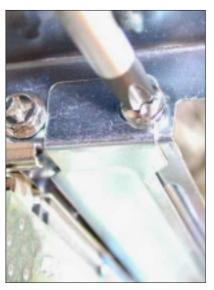
Inserta la tarjeta de red en un slot PCI libre. En un principio, procura respetar el orden de inserción no dejando ranuras PCI intermedias. Presta atención a que la tarjeta quede bien conexionada y sus contactos entren perfectamente en el conector PCI.
