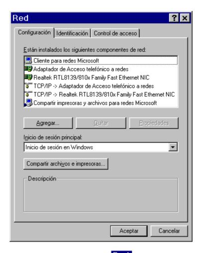
Seguramente, tu ventana Red no será exactamente igual que la nuestra que te mostramos en la figura, pero siempre te encontrarás aquí con la lista de componentes de red instalados en tu ordenador, que siempre se reducen a Clientes, Adaptadores, Protocolos y Servicios.
