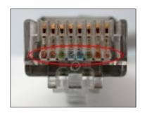
Ahora introdúcelo en la crimpadora y apriétalo lo suficiente hasta que los pines del conector hagan perfecto contacto con los hilos del cable y quede mecánicamente consistente.
