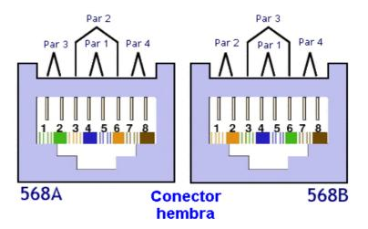
Las diferencias básicas entre uno y otro radican en que en el 568A, el par 2 del cable (naranja) termina en los contactos 3 y 6, y el par 3 del cable (verde) en los contactos 1 y 2; mientras que el 568B sólo intercambia estos dos pares.
