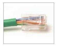
Corta de manera que la cubierta del cable quede justo en la banda que lo presiona en el conector. El destrenzado de los pares nunca debe exceder los 13 m/m.
