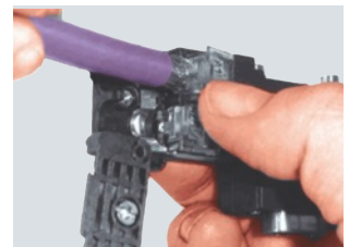
Introducir los hilos en el conector de acuerdo a sus marcas de color, apretar el inmovilizador y atornillar el alivio de tracción.
