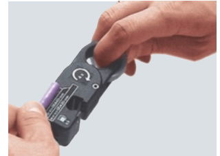
Medir la longitud de cable alineándolo con la plantilla de medida. Marcar el tope con el dedo índice de la mano izquierda.
