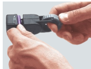
Introducir el extremo medido del cable en la herramienta hasta el índice de la mano izquierda.
