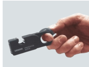
Posición inicial en la mano derecha de la herramienta peladora (FCS).
