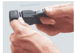
Sujetar el extremo del cable en la FCS hasta el tope.
